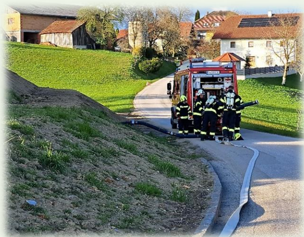
Ansaugübung in Stocket, bei der eine Saugleitung vom Löschwasserbehälter ausgehend gelegt wurde und ein in Flamme stehendes Objekt mit Schaum gelöscht wurde.
