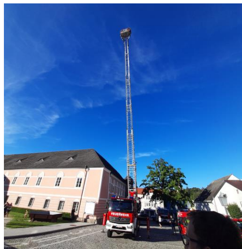
Vorstellung und Empfang der neuen Drehleiter in Peuerbach mit knickbarem Leiterteil.
